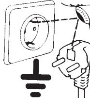
2.5 Электрическая безопасность шкафа обеспечена лишь в том случае, если он подключен к электрической системе, оборудованной эффективным **заземлением**, соответствующим действующему законодательству.
